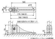
■素材/技術データ 材質:アルミダイカスト ボルト・ナット:鉄 質量:418g 環境: RoHS対応品
