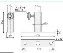
■素材/技術データ 材質:SPHC/SPCC 質量:285g
