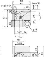
■素材/技術データ **材質:** アルミダイカスト **質量:** 193g 環境: **RoHS**対応品 耐荷重: 3250N ■付属品 六角ナットM12 (ユニクロ) ×1
